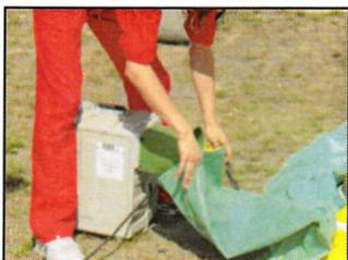
Das Gebläse an eine 220V/16A Steckdose anschließen darauf achten das alle Reißverschlüsse geschlossen sind und während des gesamten Betriebs das Gebläse laufen lassen. Möglichst eine Matte vor das Modul legen, damit die Kinder sich die Schuhe ausziehen können.
